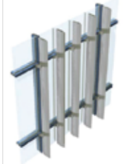
Ombrage vertical parallèle
